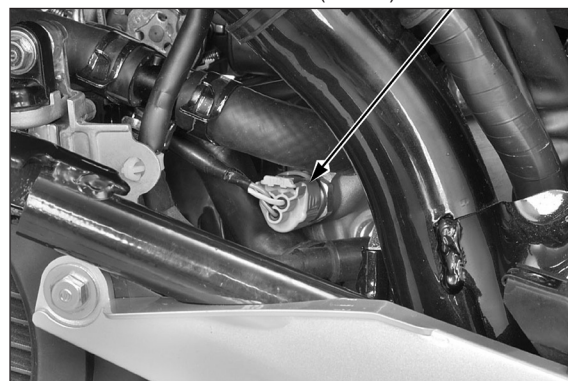
CONECTOR 3P (CINZA) DO SENSOR ECT
