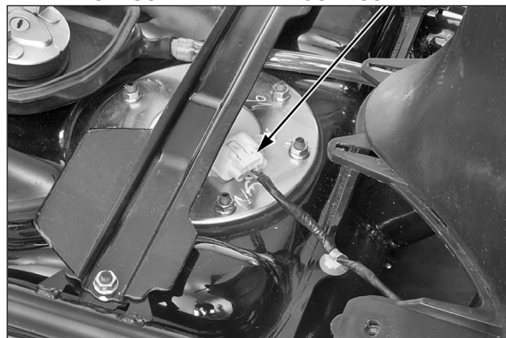
CONECTOR 5P DA BOMBA DE COMBUSTÍVEL/ SENSOR DE NÍVEL DE COMBUSTÍVEL
